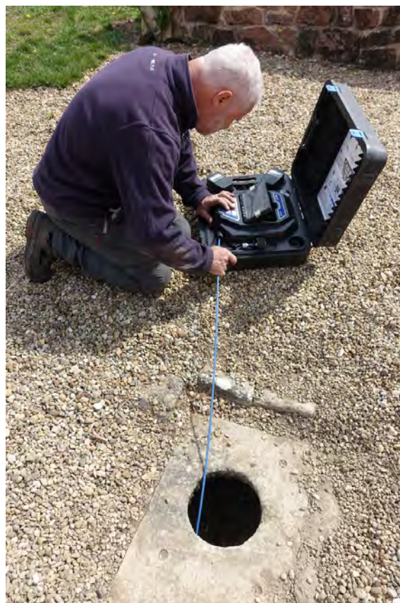
fig. 66 : Marc Noël introduisant une caméra endoscopique de type Arva dans la canalisation M23 © C. Travers
