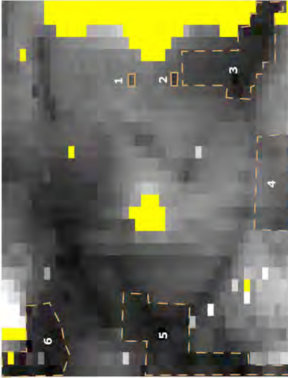
ill. 62b : Anomalies conductrices ponctuelles et diffuses (Image de résistivité EPICEHA - 2m)
