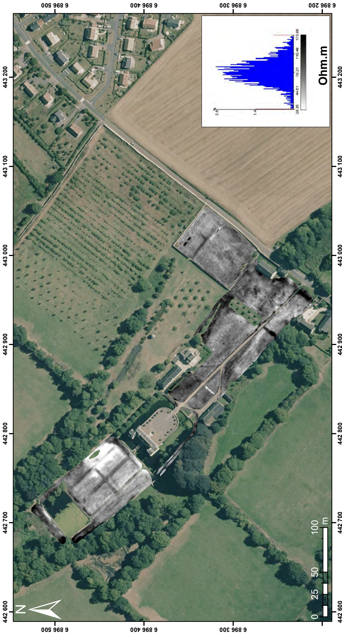
PLANCHE I : Carte de résistivité apparente - Profondeur d'investigation : 0 - 50 cm - Echelle : 28,35-173,86 ohm.m
