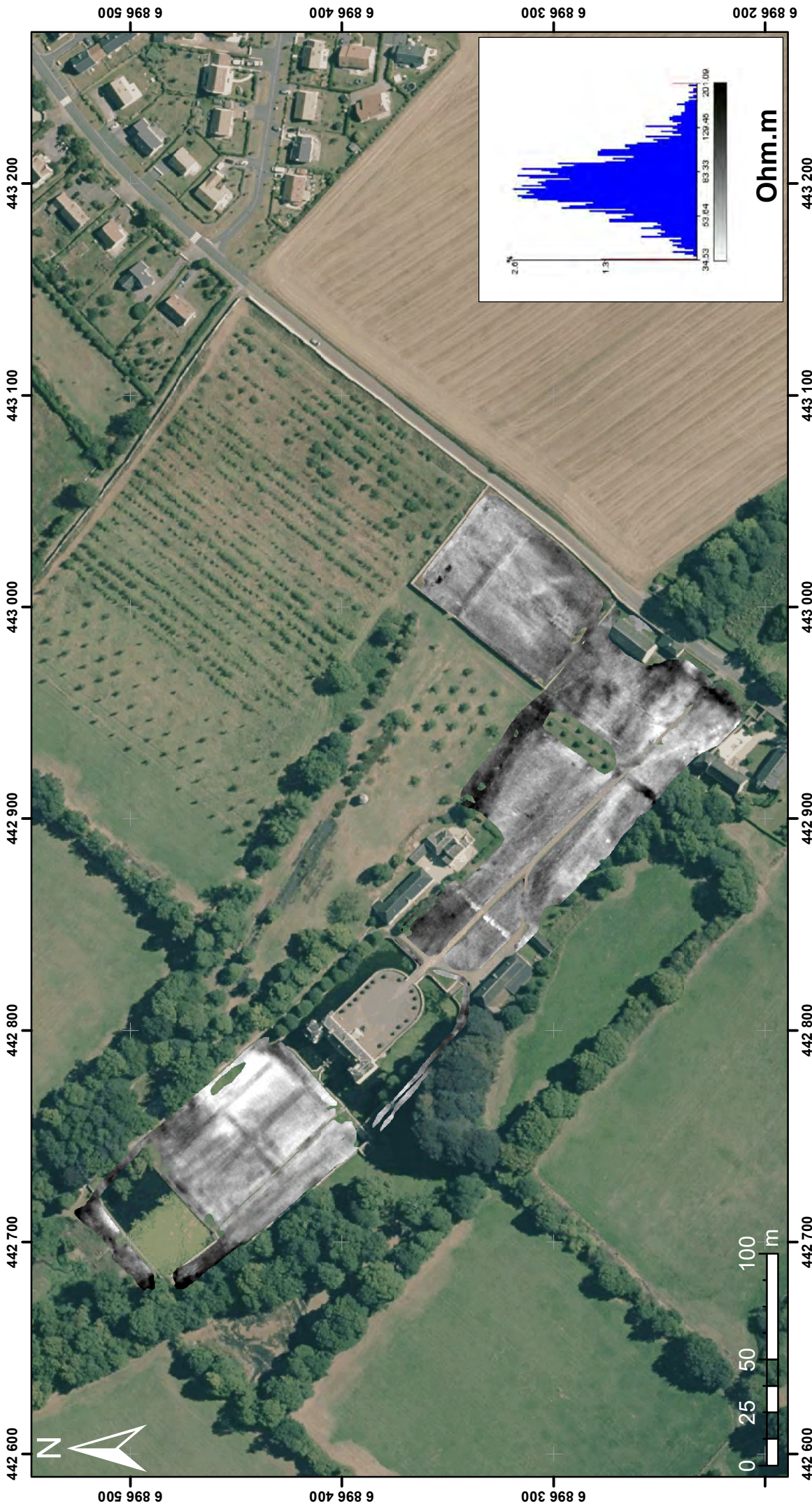
PLANCHE II : Carte de résistivité apparente - Profondeur d'investigation : 0 - 100 cm - Echelle : 34,79-201,09 ohm.m
