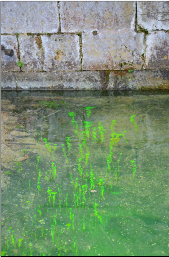
fig. 45 : Fluorescéine descendant à la verticale dans le bassin (© C. Travers)
