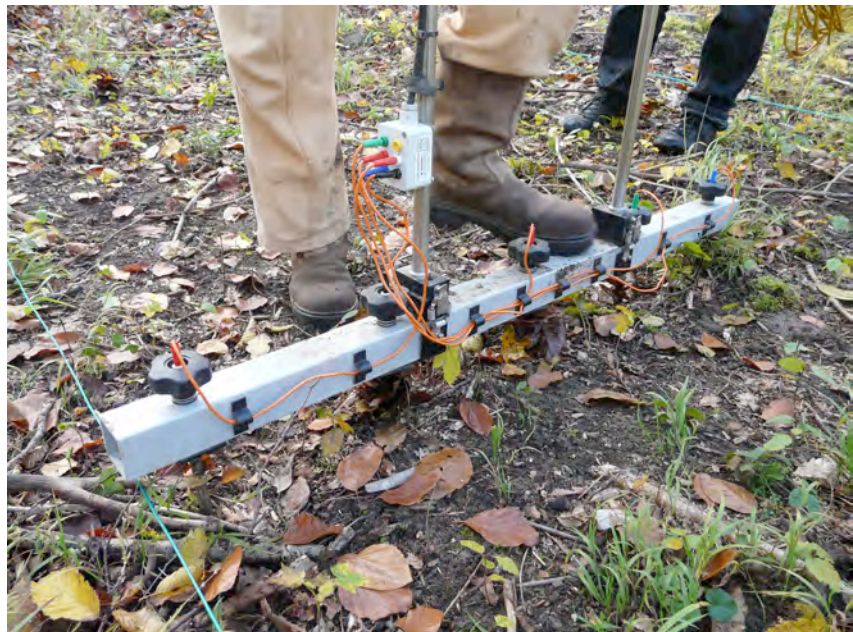
fig. 5 : Boîtier de répartition permettant de brancher les cinq électrodes au multiplexeur
